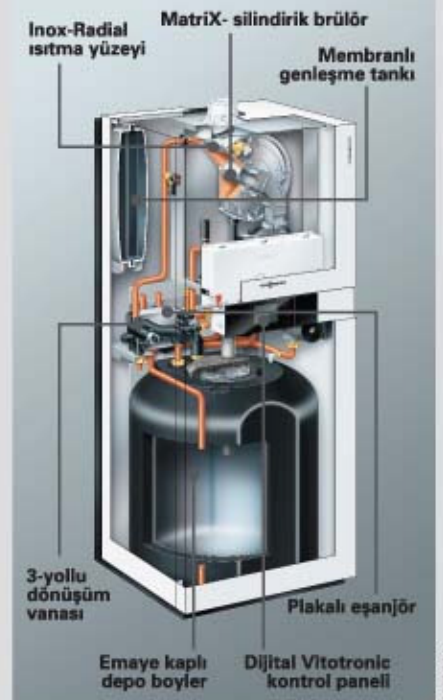
Vitodens 222-F Depo boyler entegre edilmiş gaz yakıtlı kompakt yoğunlaşmalı kazan (Boyer hacmi 100/130 litre)
